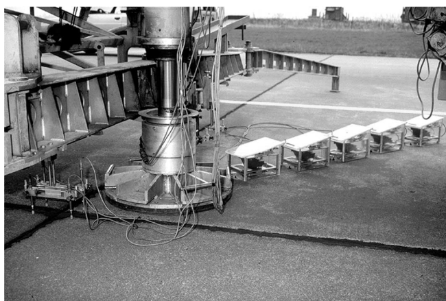
Figure 11 – Dispositif d'essai de plaque sur chaussée rigide
