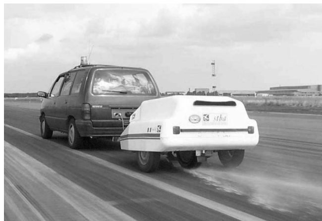
Figure 13 – APL2 (analyseur de profil en long)
